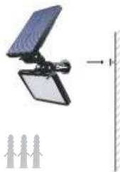
Une fois le projecteur fixé, ajustez l'orientation du capteur solaire et du spot lumineux:
